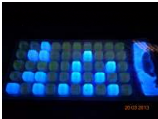
Figura 29, 30: Enterolert: Quanti-Tray (a sinistra) e Quanti-Tray /2000 (a destra) dopo l'incubazione sotto la luce UV
