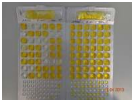
Immagine 26, 27: Colilert: Quanti-Tray/2000 dopo l'incubazione
