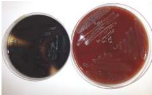
Immagine 37: Metodo ENTEROLERT; terreni ABBA e KA dopo incubazione con sviluppo di enterococchi
