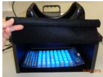
Immagine 28: Colilert Quanti-Tray/2000 nella cabina UV
