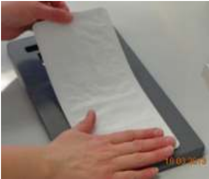
Immagine 9: posizionare Quanti-tray sulla base di gomma
