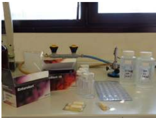
Immagine 2: Reattivi Colilert e Enterolert, ampolle, Quanti-Tray e campioni di acqua
