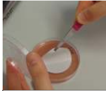
Immagine 23: Collocare il filtro su m-enterococcus
