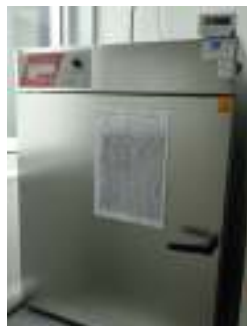
Immagine 15, 16: Incubazione della vaschetta Quanti-Tray nell'incubatore
