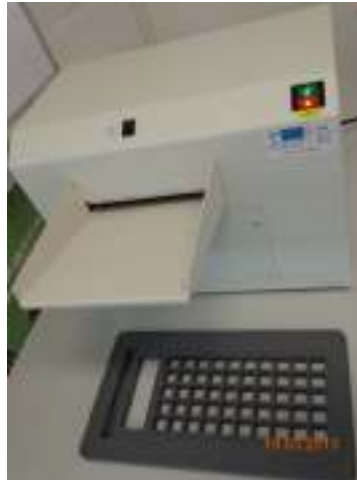
Immagine 10: Quanti Tray Sealer e base di gomma per Quanti Tray
